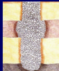
Colonnes ballastées mises en place par vibroflottation
